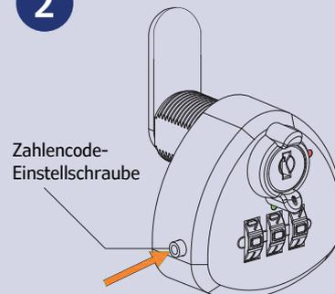
Drücken Sie die Taste für die Zahlencode-Einstellschraube und halten Sie diese gedrückt.
